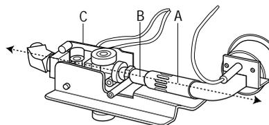
**4. CHECK THE ALIGNMENT OF THE FLAME SPREADER ON THE BURNER TUBE.**
